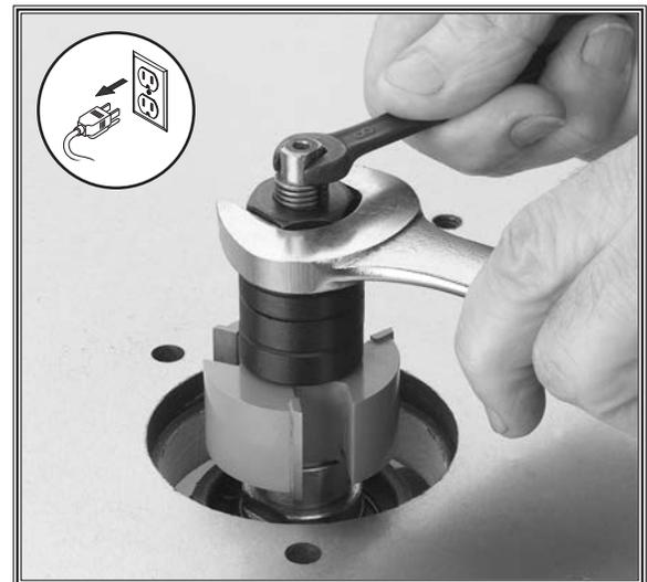
Figure 28. Tightening spindle nut.
